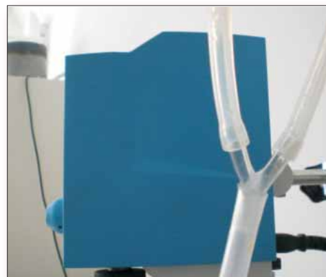
Fig. 2. Detaliu instalație: Y mixer (folosit pentru contactarea reactanților) Installation detail: Y mixer (used for contacting reactants)
