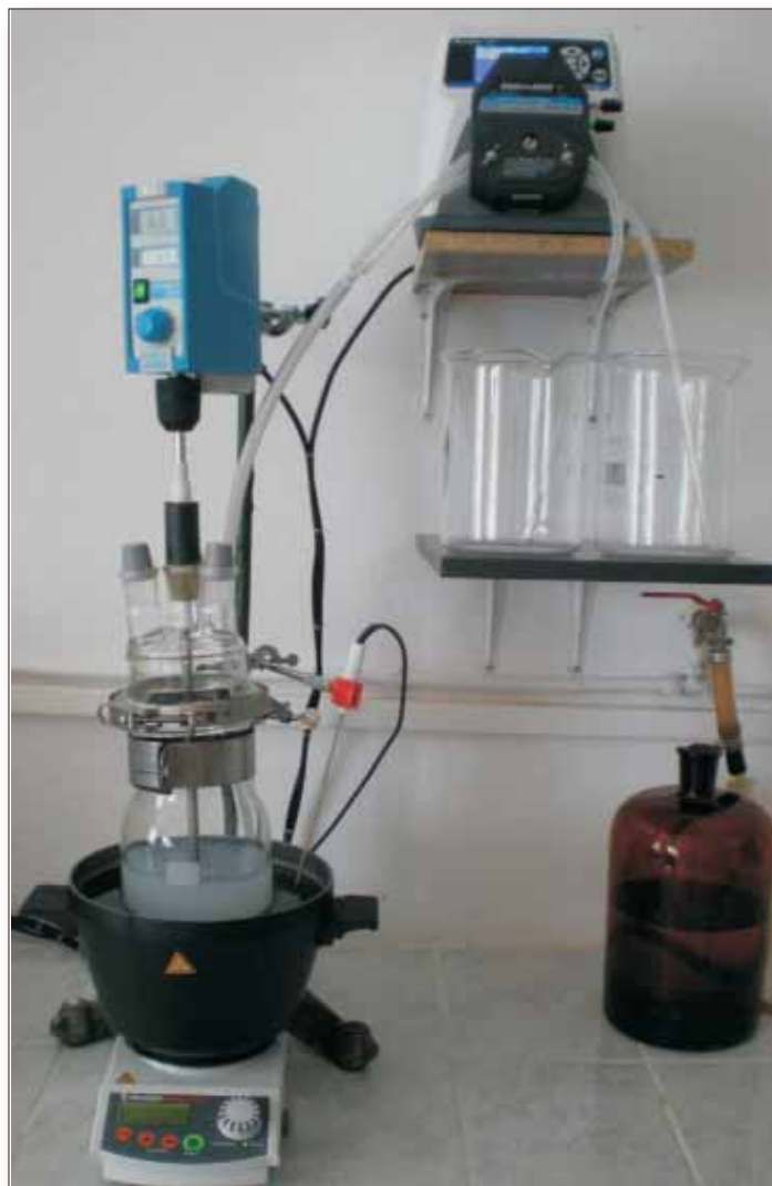
Fig. 1. Instalație pentru sinteza hidroxiapatitei Installation for hydroxyapatite synthesis
