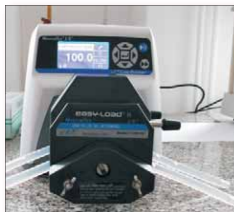
Fig. 3. Detaliu instalație: pompa peristaltică Installation detail: peristaltic pump
