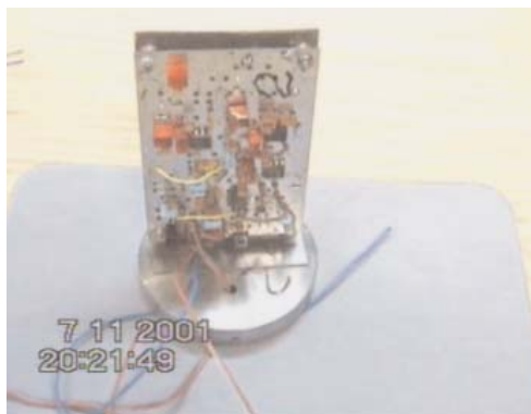
Placă de prelucrare semnal pentru focos radio de proximitate destinat bombelor de aviație
