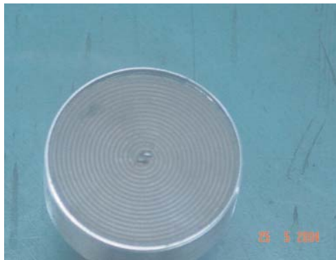
Antena spirală lui Arhimede de bandă foarte largă pentru stații de avertizare
