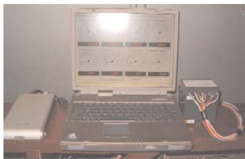
Sistem de măsură puteri, tensiuni, curenți
