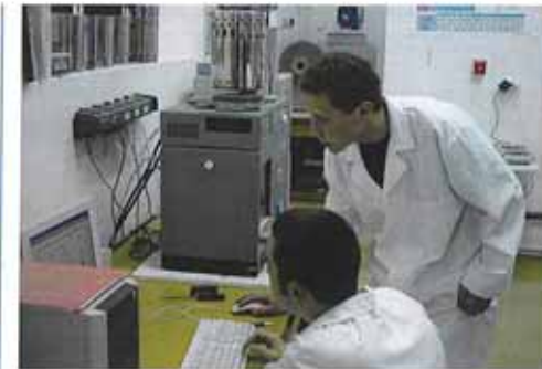
Fig.2. Echipament pentru analize termice (TG-DTA)
