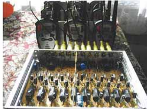
Figura 3. Sistem multicanal de recepție și demodulare MF
