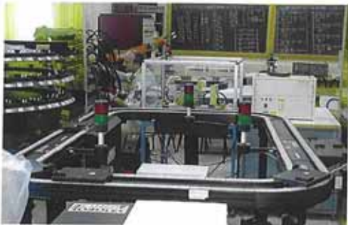
Vedere partiala a sistemului flexibil de fabricatie CIM ESHED ROBOTEC - zona conveierului
