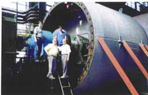
Hidrogeneratorul reversibil sincron de 14 000 kVA - teste de omologare - expertiză efectuată de echipa Facultății de Electrotehnică din Timișoara din Laborator D109 - Testare mașini electrice cu sisteme de achiziție și prelucrare a datelor
