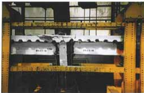
Încercări experimentale pe noduri riglă-stâlp cu secțiune cruciformă, metalice și mixte oțel-beton.
