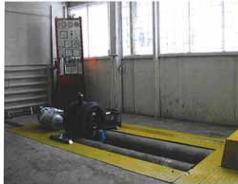
Standul cu role pentru încercarea autoturismelor adaptat special în cadrul grantului A776/2005 și pentru variantele cu propulsie neconvențională (propulsie termică alimentată cu Gaz Petrolier Lichefiat sau Gaz Natural Comprimat, propulsie electrică sau electrică hibridă)
