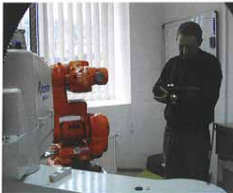
Fig.1. Programarea on-line a roboților industriali (sala G118A)
