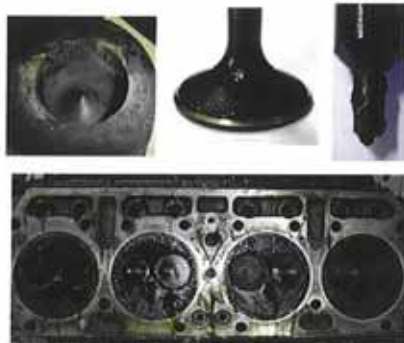
Fig.6. Elemente componente ale motorului D118 după 200 de ore de funcționare cu biocombustibil
