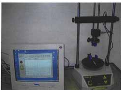
Stand motorizat pentru încercări de tracțiune MULTITEST 5-1 (jos)
