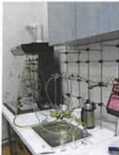
Fig.9 Linie de vid/Ar pentru sinteza in atmosfera controlata a precursorilor
