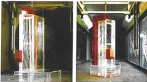
Modelul rigid Sc 1:100 amplasat în vena experimentală a tunelului aerodinamic TASL1.
