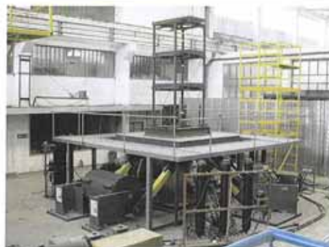
Vedere generala a platformei seismice anco
