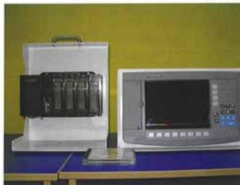
Fig. 5. Sistemul distribuit HC900 (Honeywell)
