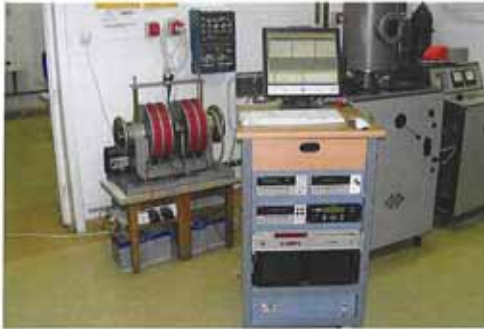
Fig.6. Instalatie pentru masurare rezistivitatii electrice si a magnetorezistentei
