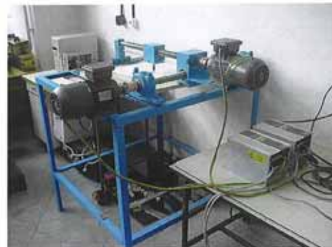
Sistem de automatizare pe baza de automat programabil Simatic S7
