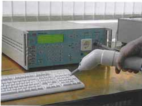
Încercari de Descarcari Electrostatice în Laboratorul de Compatibilitate Electromagnetica
