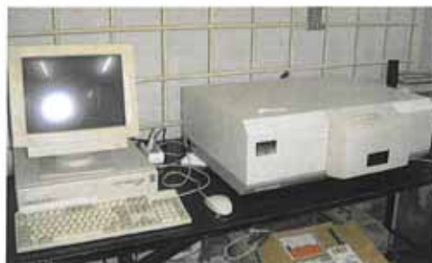
Spectrofotometru pentru determinarea proprietatilor optice ale hartiei, LS 50B, 1993
