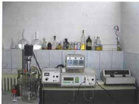
Aspect al bioreactorului Braun aflat în Laboratorul de biotehnologie generală și bioreactoare al Facultății de Biotehnologie
