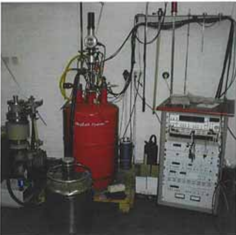
Echipament cu bobina supraconductoare de 9 T.
