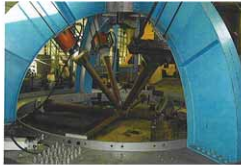
Încercare experimentală pe un nod al structurii reticulate și simulări cu metoda elementului finit pe același nod.
