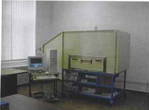
Aspect din Laboratorul de Compatibilitate Electromagnetica • Celula TEM
