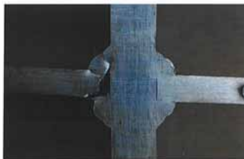
Încercări experimentale pe detalii de sudură.
