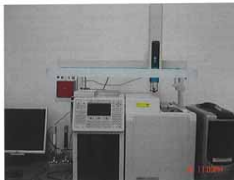
Cromatograf de gaze cu detectori ECD, NPD, FID
