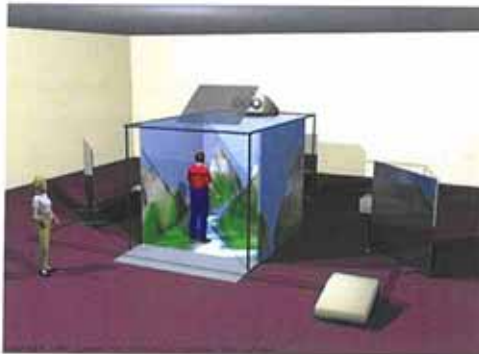
Fig.5. Sistemul CAVE de vizualizare stereoscopică combinat cu sistemul haptic SPIDAR
