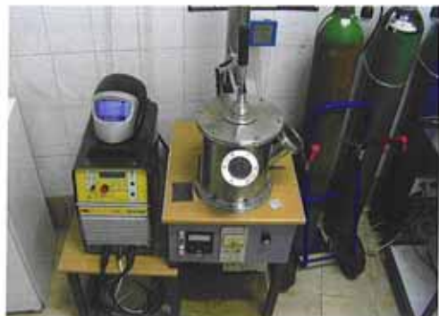
Fig.5. Cuptor de sinteză în plasmă de Ar
