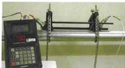
Debitmetrul ultrasonic folosit pentru măsurarea debitelor în conducte sub presiune
