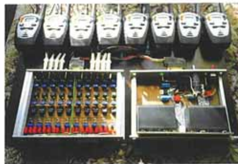
Figura 4. Sistem multicanal de măsurare tensometrică, modulare și emisie MF
