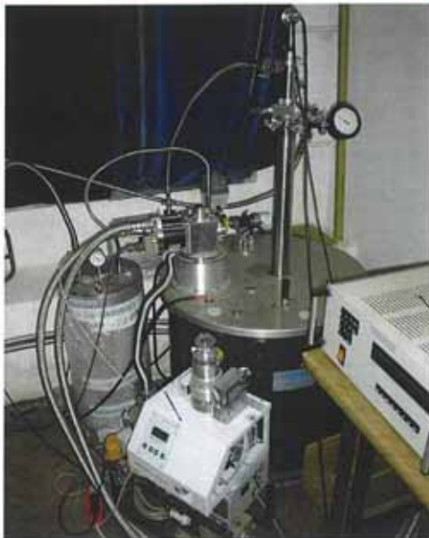
Instalație de masura a rezistivitatii in campuri de pana la 7 T.
