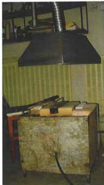
Cuptor cu bare de siliciu şi cu termoreglare pentru elaborarea aliajelor cu bază de aluminiu 1995-2000
