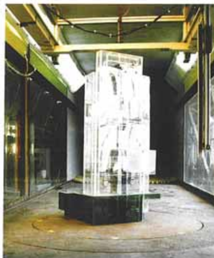
Modelul aeroelastic Sc 1:100 amplasat în vena experimentală a tunelului aerodinamic TASL1
