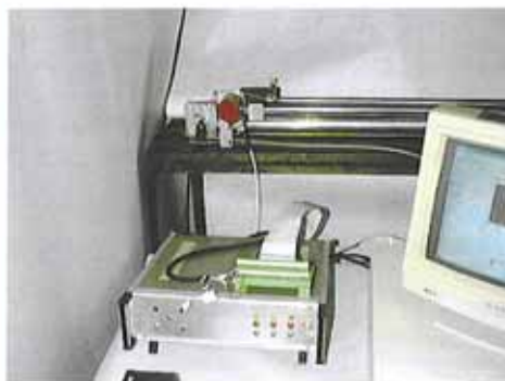
Testarea asistata de calculator a unui cilindru pneumatic la S.C. ICTCM S.A.
