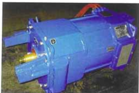
Motor asincron pregătit pentru testare (utilizat în tracțiune electrică urbană)
