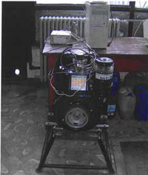
Fig.2. Stand motor monocilindric pentru ridicarea diagramei indicate
