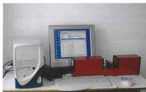
TSoftware pentru sistem computerizat de masurare dimensionala cu laser, realizat entru INCDMF CEFIN Bucuresti
