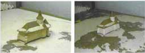
Metoda amprentării. a - fara obstacol amonte; b - cu obstacol amonte
