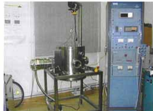
Fig.4. Tun cu fascicul de electroni de 10 kW dotat cu creuzet rotativ cu 6 posturi (presiunea limită 10 -8 Torr)
