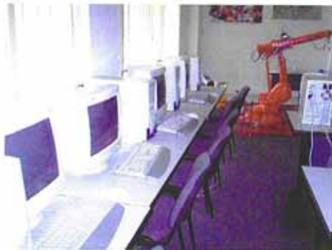
Robotul ABB IRB 1400 si vedere partiala a retelei de calculatoare folosita pentru fabricatie virtuala
