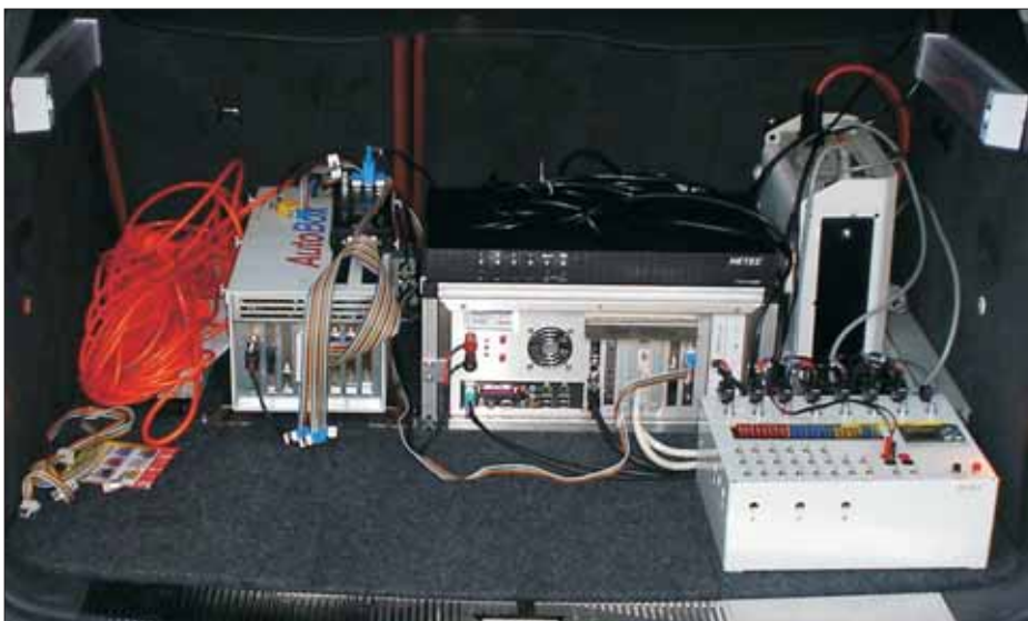
Computerul folosit pentru procesarea imaginilor, la bordul vehiculului de test
