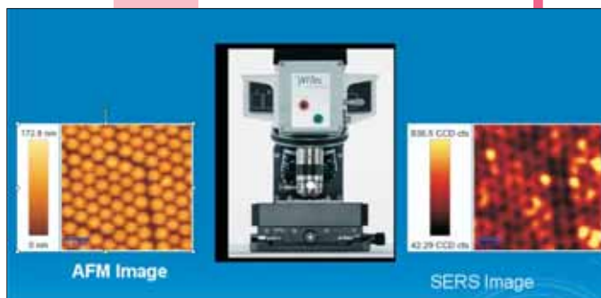
Imaginea plasmonică obținută prin scanarea semnalului SERS (stânga) în comparație cu imaginea topografică a substratului obținută prin AFM (dreapta)
