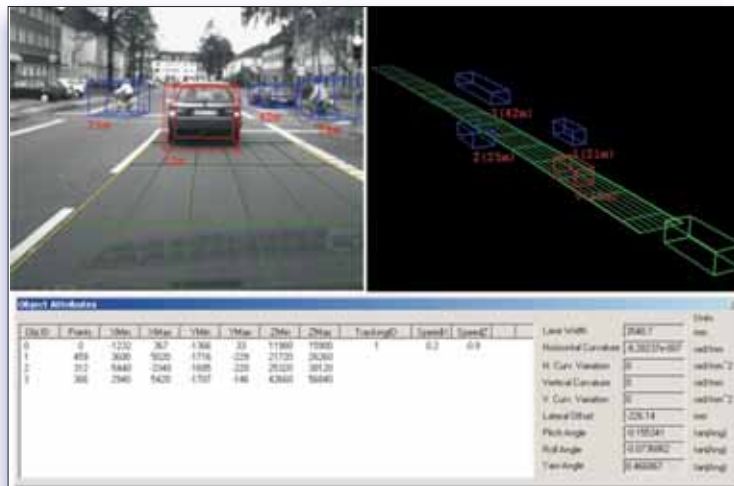
Aplicația de asistență a conducerii în traficul urban bazată pe stereoviziune
