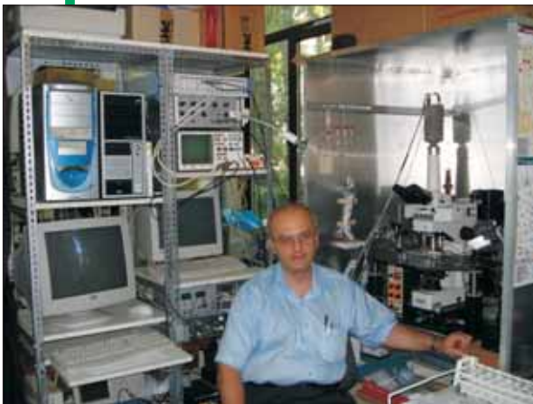
Instalația de măsurare a curenților ionici prin canalele proteice transmembranare
